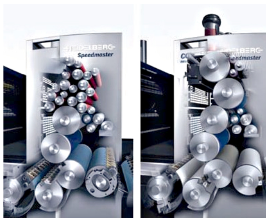
Obr. 4. Tisková jednotka Speedmaster SX 52 s běžným konvenčním barevníkem (vlevo) a s Anicolor jednotkou.
