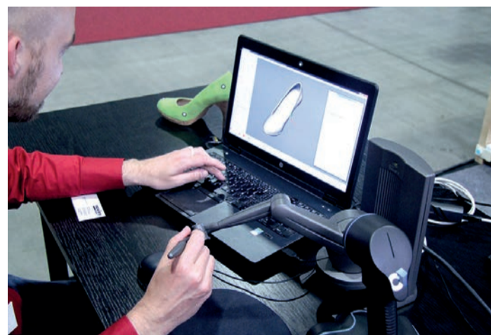
Haptický stylus pre modelovanie 3D objektov prináša neuvěřiteľnú voľnosť dizajnérom. Naozaj som cítil reliéf.
