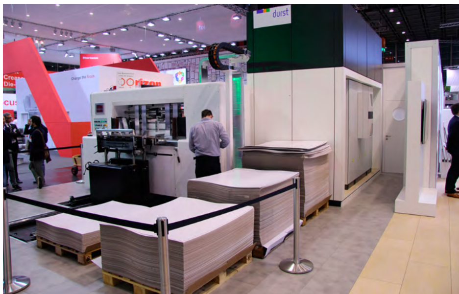
Nový podavač, který šetrným způsobem dodává archy lepenky bez toho, aby ji poškodil promáčknutím či orážením hran
